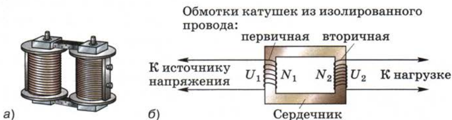
Рис. 134. Внешний вид и схема устройства повышающего трансформатора
