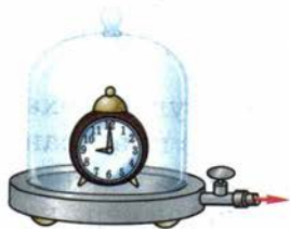
Рис. 80. Опыт, доказывающий, что в пространстве, где нет вещественной среды, звук не распространяется
