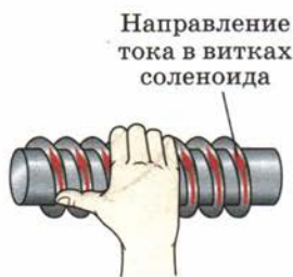
Рис. 97. Определение направления линий магнитного поля внутри соленоида
