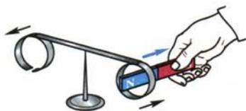
Рис. 126. При удалении магнита от сплошного кольца оно, притягиваясь, следует за магнитом
