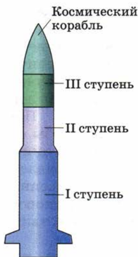
Рис. 49. Схема трёхступенчатой ракеты
