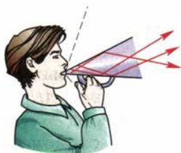
Рис. 82. Принцип действия рупора
