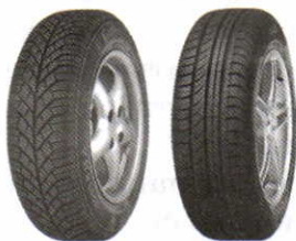
Рис. 86. Ребристые выступы на шинах позволяют увеличить трение
