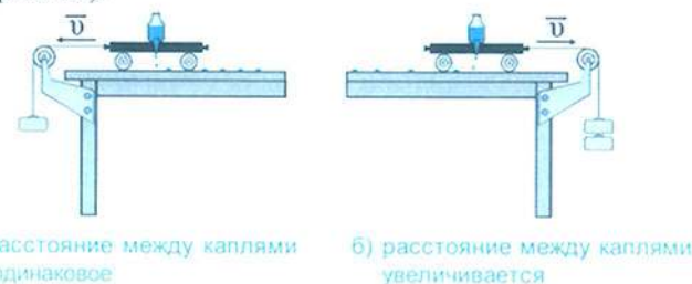
Рис. 12. Опыт, показывающий равномерное и неравномерное движение.
