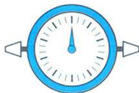
б) динамометр для измерения тяговой силы машин, тракторов, локомотивов.
