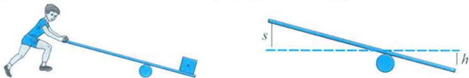
Рис. 129. Равенство работ при использовании рычага.
